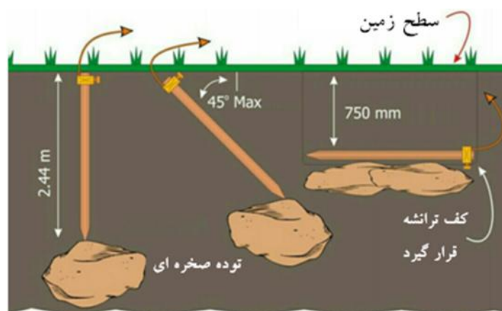
شکل (۵-۲): صورت‌های مجاز اجرای الکترودهای میله‌ای (۲۵۰.۵۳ Art: ۲۰۱۴ NEC)
