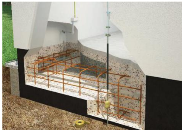
شکل (۲-۱۱): الکتروود مدفون در بتن
